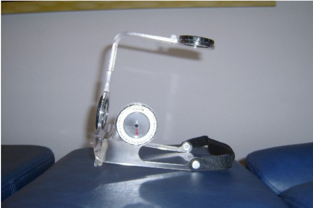
Foto 3. Inclínómetros pendulares gravitacionales del Goniómetro del Rango Movimiento Cervical (CROM®) SP-5060. Vista lateral.
