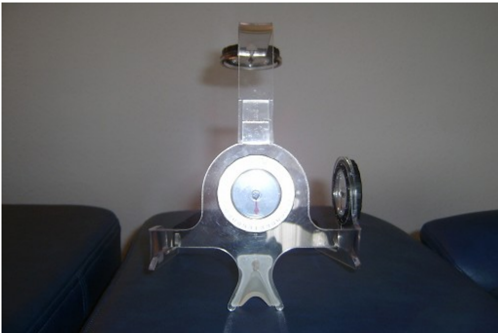
Foto 2. Inclinómetros pendulares gravitacionales del Goniómetro del Rango Movimiento Cervical (CROM®) SP-5060. Vista frontal.
